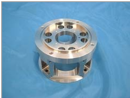
チャンパー部品 材質: SUS303 NC旋盤加工 + NC切削加工
