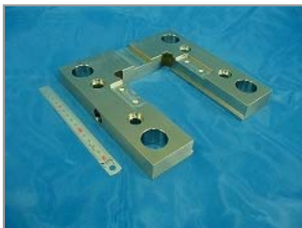
工作機器部品 材質: NACK55 NC切削加工 + ワイヤークット加工 + 研削加工
